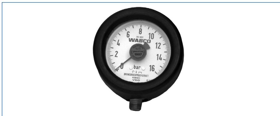
Die Abbildung zeigt das Prüfmanometer 453 004 007 0 mit dem Skalenendwert 16 bar. Quer zur 0-Marke liegt der Markierungsstrich, der Auskunft über die zulässige Abweichung der Zeigerstellung in Ruhelage gibt. Daneben liegt das Lagezeichen, das bei Anwendung des Messgerätes beachtet werden muss.
