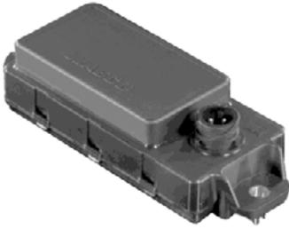
Das ESC-Steuermodul verarbeitet die Daten aus dem Gierraten-, dem Querbeschleunigungs- und dem Lenkwinkelsensor und kommuniziert mit dem EBS-Steuergerät über den EBS-Datenbus. Der Gierraten- und der Querbeschleunigungssensor sind im ESC-Steuermodul integriert.
