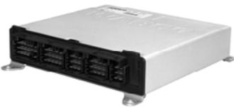
Das Zentralmodul steuert und überwacht das elektronisch geregelte Bremssystem. Es ermittelt die Sollverzögerung des Fahrzeugs aus dem Signal des Bremswertgebers. Die Sollverzögerung und die Radgeschwindigkeiten, die durch die Drehzahlsensoren gemessen werden, bilden gemeinsam das Eingangssignal für die elektro-pneumatische Regelung. Aus dem Eingangssignal berechnet das Zentralmodul die Drucksollwerte für die Vorderachse, die Hinterachse und für das Anhängersteuer-ventil.
