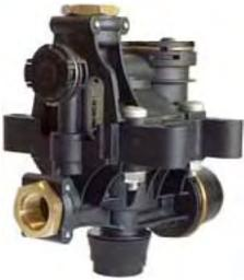
Das Reduzierventil ist ein mechanisch wirkendes Druckverhältnisventil und wird im EBS System 1C [F] eingesetzt. Es reduziert den vom Zentralmodul angesteuerten redundanten Betriebsdruck, der zum Achsmodulator führt. Die Reduzierung erfolgt in einem festgelegten Verhältnis von ca. 2:1.
