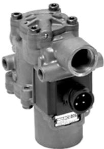
Die ABS-Magnetregelventile sind an der Vorderachse eingebaut. Im normalen Fahrzustand sind die Ventile geöffnet und steuern den vom Proportional-Relaisventil angesteuerten Druck zu den Bremszylindern durch. Im ABS-Fall schließen sich die Einlassventile und lassen keinen neuen Druck zum Bremszylinder durch. Falls die Reifen dennoch weiterhin blockieren, wird über einen zusätzlichen Ausgang im Ventil Druck abgelassen.
