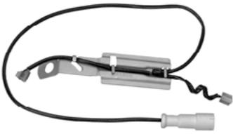
Der Bremsbelagverschleißindikator besteht aus einem elektrischen Kontakt, der im Bremsbelag liegt. Sobald der Bremsbelag verschlissen ist, wird ein Draht durchtrennt und dadurch der Stromkreis unterbrochen. Die Elektronik meldet daraufhin dem Fahrer, dass die Bremsbeläge ausgetauscht werden müssen.
