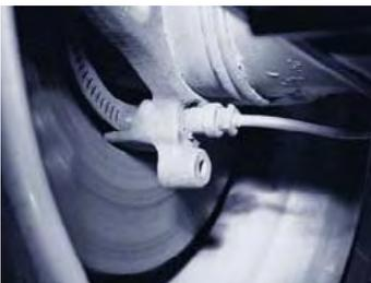
Über ein Polrad ermittelt der Drehzahlsensor permanent die aktuelle Radgeschwindigkeit und leitet diese Daten an die EBS-Elektronik weiter, die anhand von Referenzwerten die aktuelle Geschwindigkeit ermittelt. Bei Abweichungen vom Normalzustand greift das System regulierend in die Brems- und Motorsteuerung ein.
